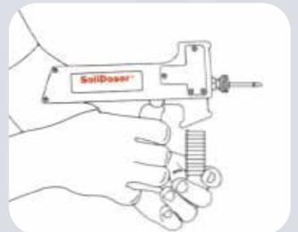
**09** El clip se expulsará automáticamente después de administrar la 10ª dosis. NO guarde un clip cargado en el dispositivo, ya que los perdigones pueden hincharse y atascar la pistola. Siempre proteja la pistola y el producto de la humedad.
