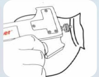
**A.** En el improbable caso de que un clip no avance, se puede avanzar manualmente utilizando una sonda o un lápiz como herramienta.
